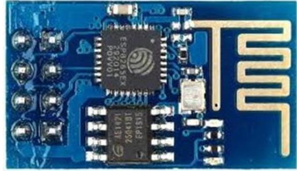
Fig: Wi-Fi Module ESP8266
