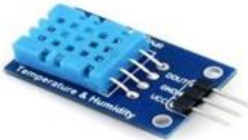
Fig: DHT11 Sensor
