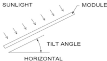
Fig 10. Module Tilt Angle
