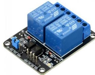
Fig2: Relay module
